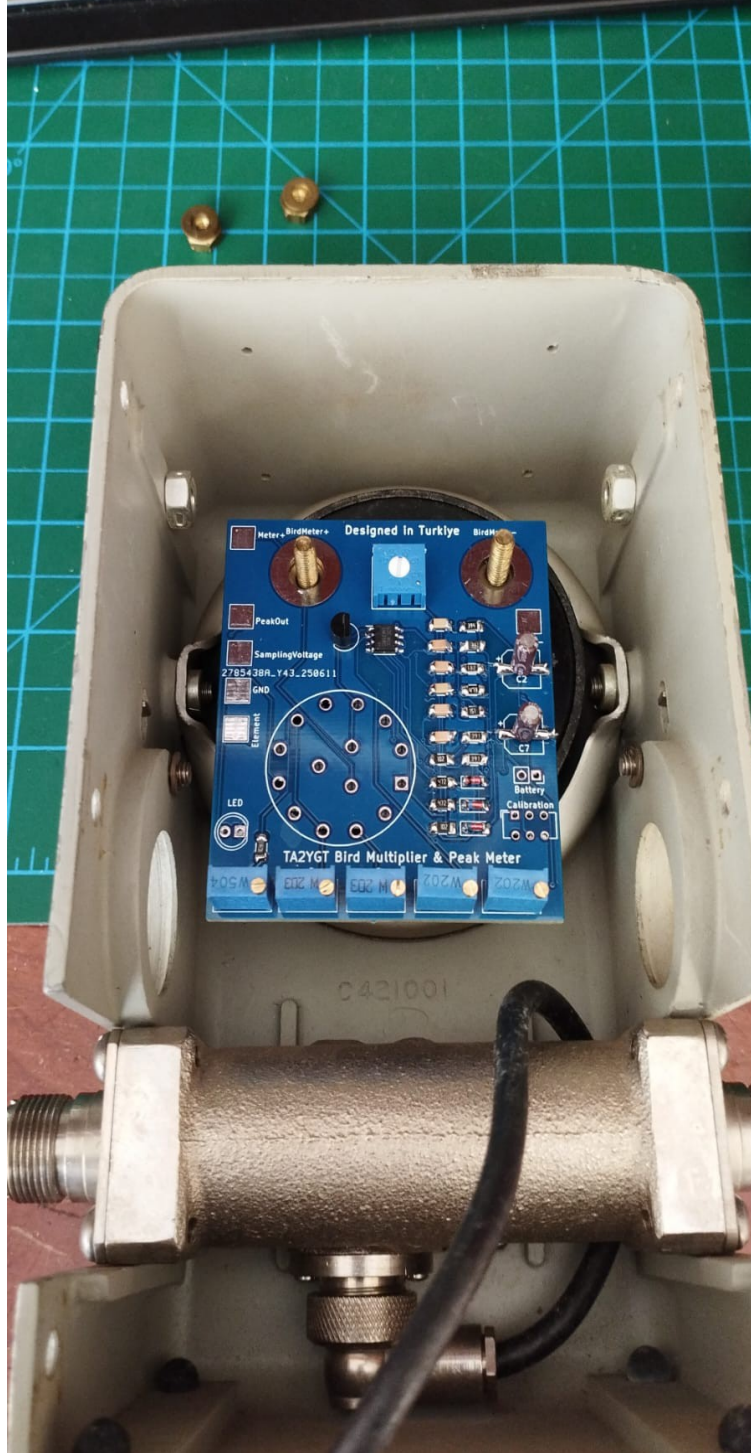
Şekil 1.b: Mikro ampermetreye devrenin montajı
